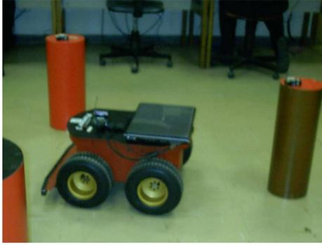
Figura 5: Robô Pioneer P3AT coletando os dados de três nós sensores Mica2.
